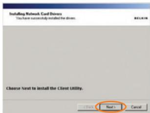
**3.1** Terminata l'installazione del driver della scheda di rete, fare clic su "Next" (Avanti) per installare la "Wireless Client Utility" (utility per client wireless).
