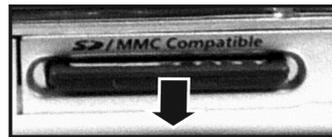
La Memory card tornerà verso l'alto automaticamente. Togliete la Memory card seguendo l'indicazione della freccia.
