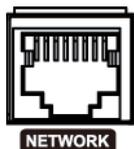
Il DVR può essere collegato in rete tramite connettore Ethernet da 10/100Mb. Collegare un cavo Cat5 con un jack RJ-45 al connettore del DVR. Il DVR può essere collegato in rete con un computer per eseguire da remoto il comando, la ricerca, la configurazione e gli aggiornamenti software.
