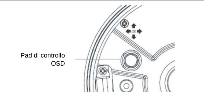
Figura 3: Pad di controllo OSD
