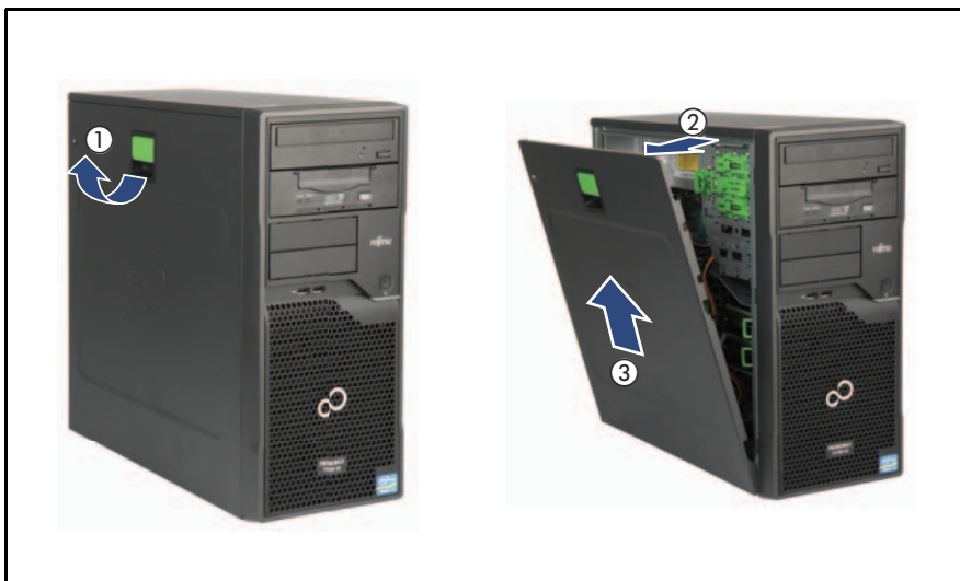
Immagine 4: Rimozione del coperchio
