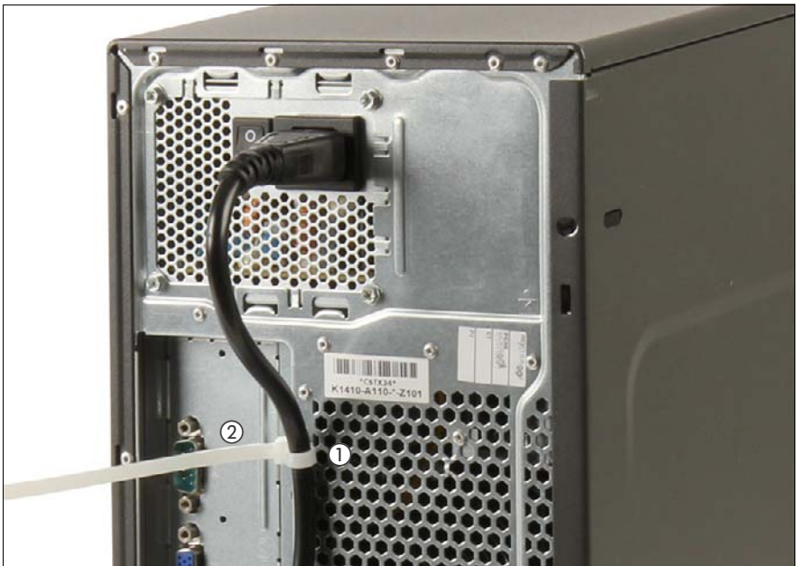
Immagine 3: Fissaggio del cavo di alimentazione
