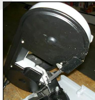
Figura 16 – A: Guida lama e leva tendi lama, B: Carter posteriore.
