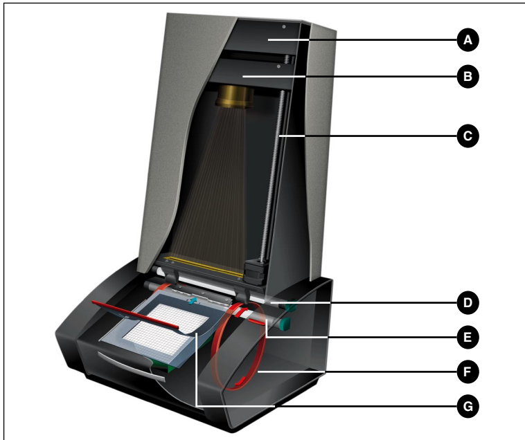
Abb. 3: Schnittansicht des Flextight Precision II
