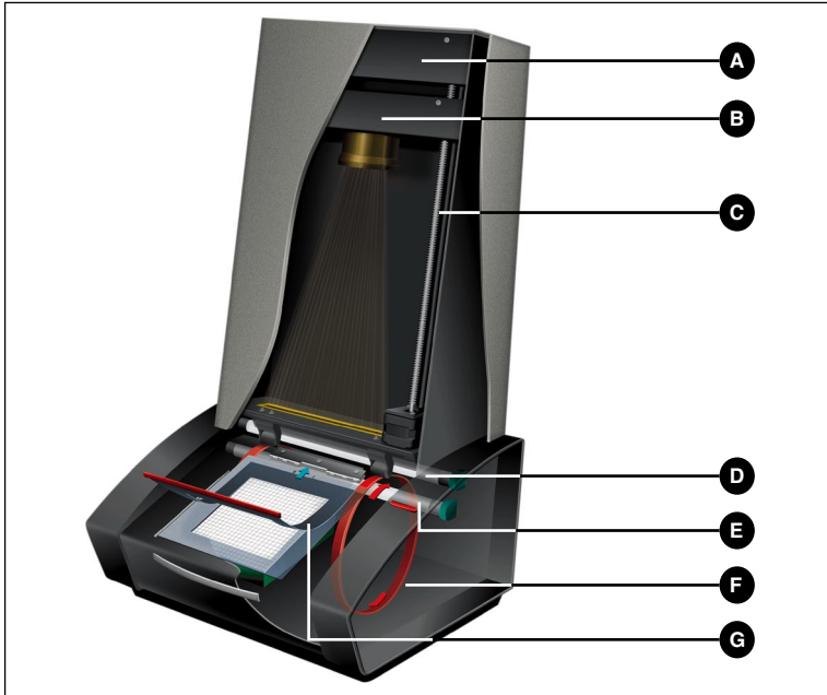
Figura 3: Vista en corte del Flextight Precision II
