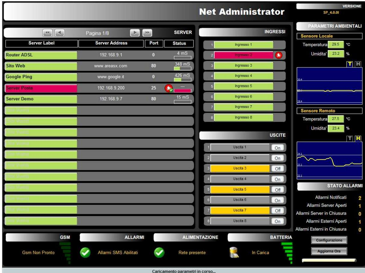
Da questo pannello è possibile controllare lo stato dell'intero sistema (server, ingressi, uscite, temperatura, umidità, batteria) ed attivare o disattivare le uscite. E' inoltre presente un pulsante per accedere al pannello di configurazione ed uno per aggiornare i parametri visualizzati.
