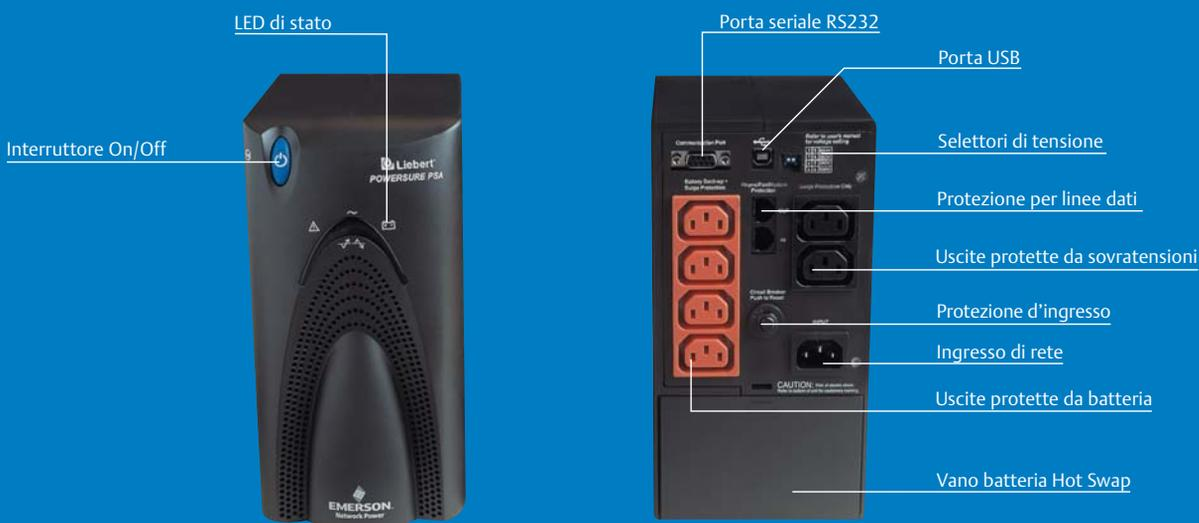
**Le uscite protette da batteria** offrono protezione da sovratensioni in aggiunta all'autonomia della batteria in caso di mancanza di rete. Le uscite protette da Sovratensioni proteggono da anomalie quei dispositivi che non necessitano di autonomia in caso di black-out (stampanti a getto d'inchiostro, scanner, apparecchiature multimediali).
