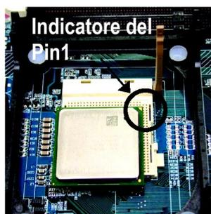
4. Trovare il Pin 1 nel socket e cercare uno spigolo (dorato) nell'angolo superiore della CPU. Quindi inserire la CPU nel socket.
