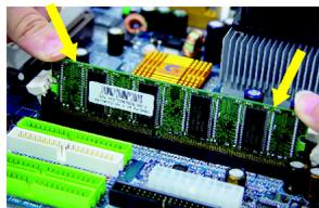
3. Chiudere le clip di plastica su entrambi i lati degli slot DIMM per fissare le memorie DIMM. Seguire i passi dell'installazione al contrario nel caso si volesse rimuovere i banchi di memoria DIMM.
