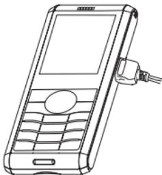
Il telefono dispone di una batteria ricaricabile. Una batteria nuova deve essere caricata per almeno 4 ore prima di essere utilizzata. La capacità massima viene raggiunta dopo alcuni cicli di utilizzo.
