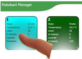
Toccano sulla finestra di riepilogo di ciascuno strumento, si apre la pagina di gestione del Modulo relativo con la visualizzazione in dettaglio di tutte e 35 le posizioni dello strumento:
