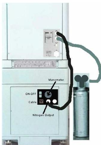
8 - Per il **Robobact Special** (94210) si deve inoltre effettuare il collegamento con le bombole esterne di CO<sub>2</sub> e N<sub>2</sub> mediante i tubi in dotazione .Le bombole devono essere provviste di riduttori di pressione con manometri. La pressione in uscita deve essere compresa tra 3 e 6 Atmosfere (Bar). Il diametro del raccordo all'uscita del manometro deve essere maschio di 3/8 di pollice.
