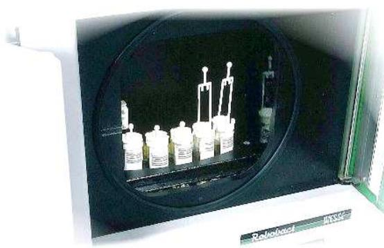
Il modulo ROBOBACT è costituito da un corpo unico che contiene tutte le funzioni operative necessarie ai fini dell'isolamento batteriologico. Lo sportello sulla parte anteriore consente l'inserimento dei campioni. Sulla parte posteriore sono presenti il connettore per l'alimentazione e quello per il collegamento Seriale/USB con il Computer. Qui di seguito sono descritte le unità funzionali del modulo.
