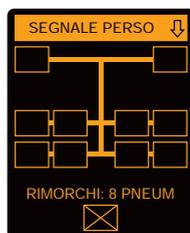
Le schermate di avvertimento individuali mostrano i simboli delle singole avvertenze. La visualizzazione delle singole schermate cambia ogni 1,5 secondi nel caso in cui per gli pneumatici visualizzati sia presente un livello alto di avvertimento. Per il significato dei simboli di avvertimento vedere il paragrafo **7.5.4 Funzionamento senza riconoscimento automatico del rimorchio - panoramica messaggi di avvertimento.**
