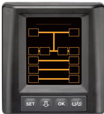
Il sistema CPC è pronto al funzionamento. I dati sugli pneumatici vengono visualizzati volta per volta al più tardi dopo l'inizio del viaggio.
