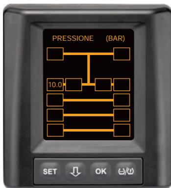
Vengono ricevuti i dati sugli pneumatici per la posizione della ruota del 2° asse a sinistra esterno.
