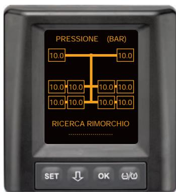
Per tutte le posizioni delle ruote dell'autocarro vengono ricevuti i dati sugli pneumatici e il riconoscimento automatico del rimorchio (ATL) non è ancora concluso.
