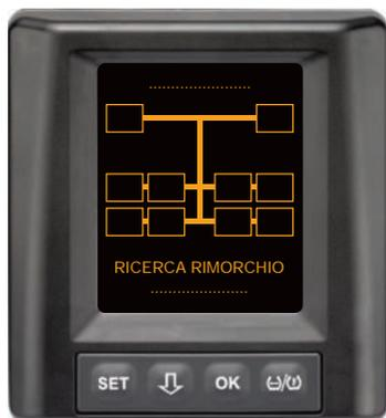
Il sistema CPC è pronto al funzionamento. I dati sugli pneumatici vengono visualizzati volta per volta al più tardi dopo l'inizio del viaggio. Il riconoscimento automatico del rimorchio (ATL) non è ancora concluso.
