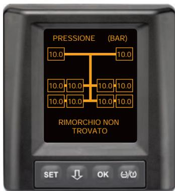
Per tutte le posizioni delle ruote dell'autocarro vengono ricevuti i dati sugli pneumatici e il riconoscimento automatico del rimorchio (ATL) è concluso, ma non è stato trovato nessun rimorchio con sensori per pneumatici.
