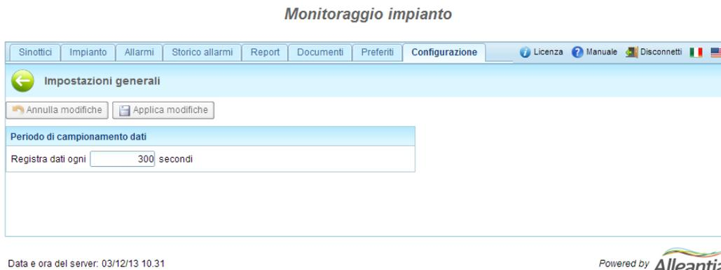
**Figura 17 – Configurazione registrazione dati**
