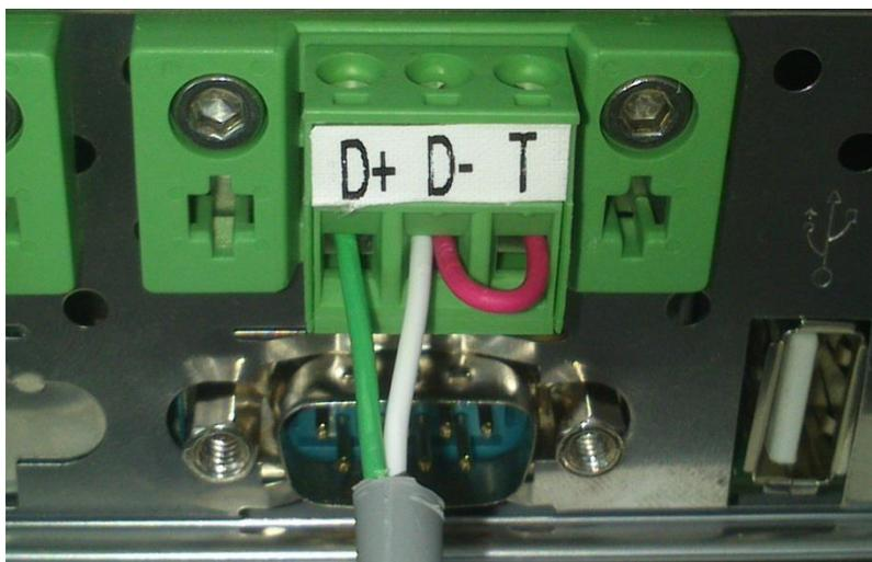
Figura 4 - RS485 integrata con terminazione interna abilitata (ponticello tra i terminali D- e T). Se non si vuole utilizzare la terminazione non ponticellare i terminali.
