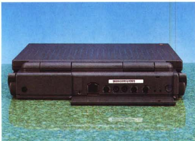
Il lato posteriore con la presa d'alimentazione, e le diverse uscite e pulsanti descritti nel testo; evidente la particolare forma della SCSI, alla estrema sinistra. Ai due estremi, i piedini che permettono di inclinare la base di circa 10°.
