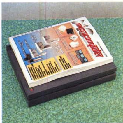
La macchina chiusa, a confronto con una copia della rivista; si noti, sul frontale, la chiusura a pulsante e, lungo tutto il perimetro, la profonda scalfitura di appoggio per l'apertura della macchina.
