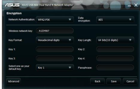
dati inviati e decodificare i pacchetti dei dati ricevuti. Il processo crittografico rende indecifrabili i bit dei frame per impedirne la rivelazione ad altri. WPA (Wi-Fi Protected Access) è un sistema di protezione migliorato per 802.11, che permette di codificare i dati trasmessi su onde radio. Il sistema WPA è stato sviluppato per superare le debolezze del protocollo WEP.
