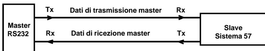
**Figura 6 Schema di collegamento al sistema per lo standard RS232**
