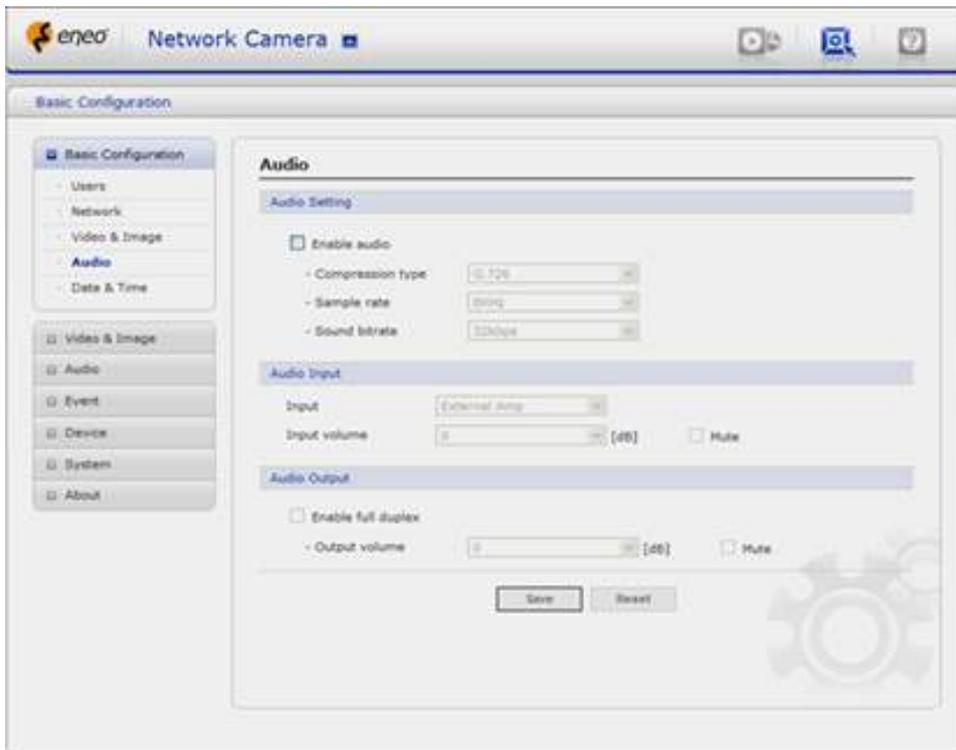
La NLC-1401 può trasmettere audio ad altri client utilizzando il microfono esterno e riprodurre l'audio ricevuto da altri client mediante un altoparlante. La pagina Setup (Configurazione) possiede un menu supplementare denominato **Audio**, che consente differenti configurazioni audio come full duplex e simplex.
