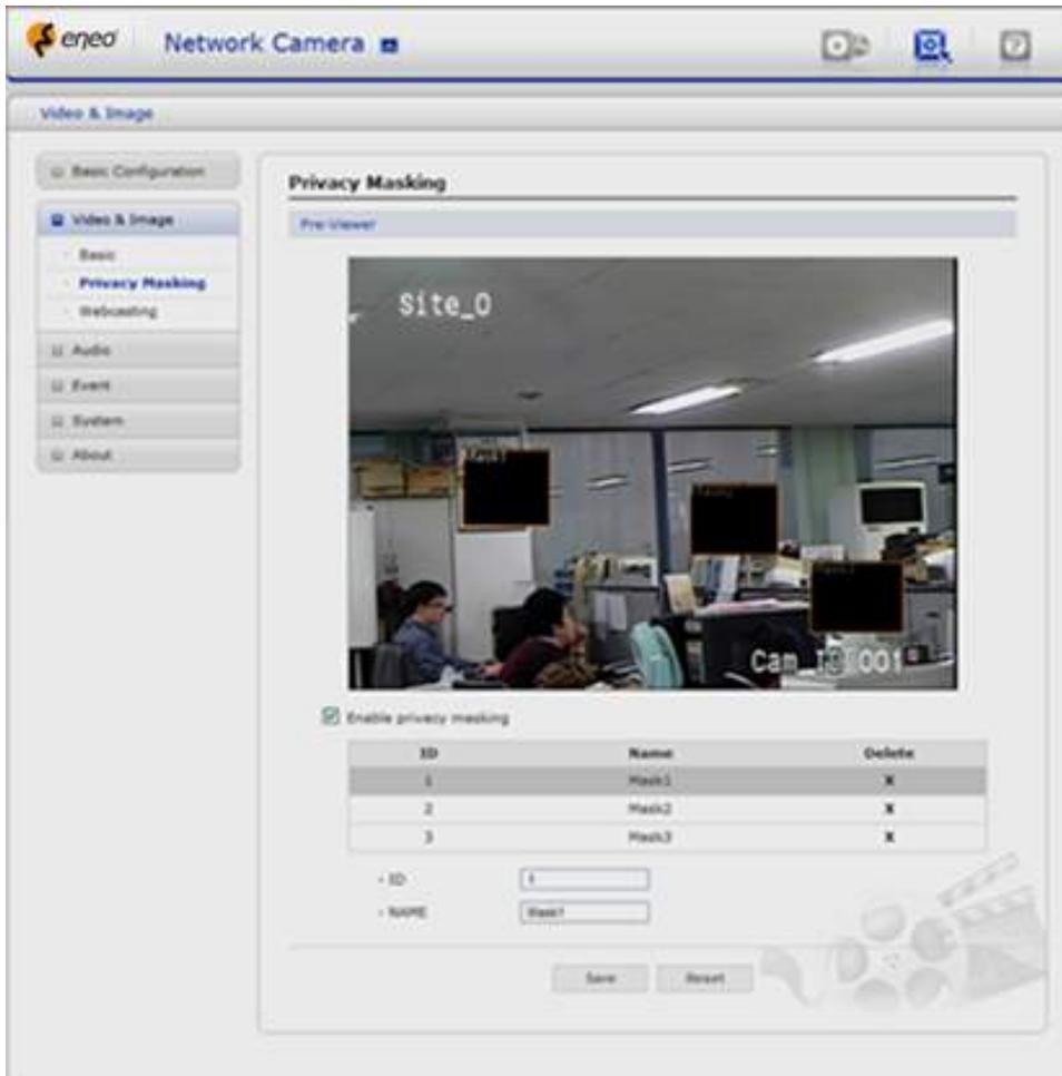
Le zone protette sono configurate da finestre Mask. Ciascuna finestra può essere selezionata facendo clic col mouse. È inoltre possibile **ridimensionare (resize)**, **eliminare (delete)** o **spostare (move)** le finestre, selezionando quella appropriata sul menu del mouse sullo schermo del video.
