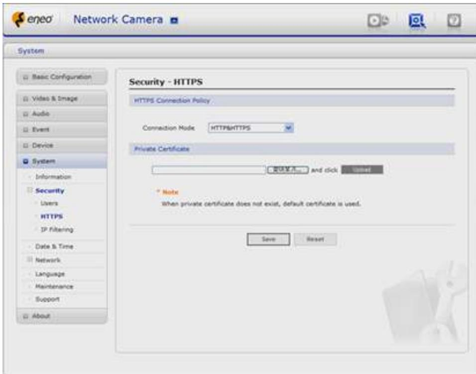
Per maggiore sicurezza, la NLC-1401 può essere configurata per l'utilizzo del protocollo HTTPS (Hypertext Transfer Protocol over SSL (Secure Socket Layer)). In tal modo, tutte le comunicazioni che sarebbero altrimenti trasmesse via HTTP avvengono invece attraverso la connessione criptata HTTPS.
