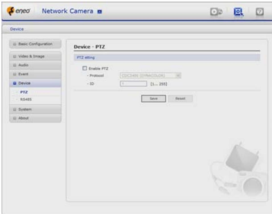
La NLC-1401 supporta diversi dispositivi PTZ o PT. Utilizzando il cavo appropriato, collegare il dispositivo alla porta RS-485. Queste porte sono disponibili tramite il connettore del terminale I/O.
