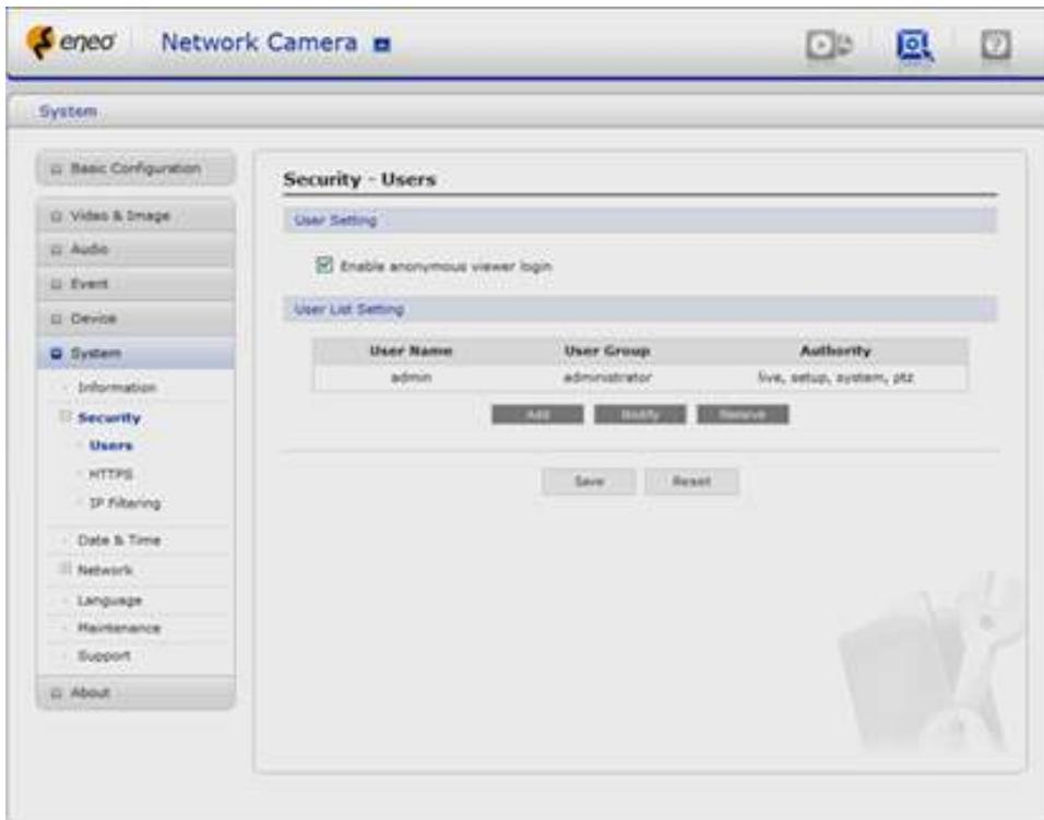
Il controllo dell'accesso da parte degli utenti è abilitato per default, quando l'amministratore imposta la password di radice in occasione del primo accesso. I nuovi utenti sono autorizzati tramite i nomi utente e le password, ma l'amministratore può comunque consentire una connessione anonima alla pagina Live View, come descritto nel seguito:
