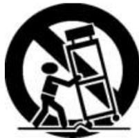
L'apparecchio e il relativo carrello devono essere movimentati con cura. Arresti improvvisi, forza eccessiva e superfici irregolari possono causare il ribaltamento del carrello e dell'apparecchio.
