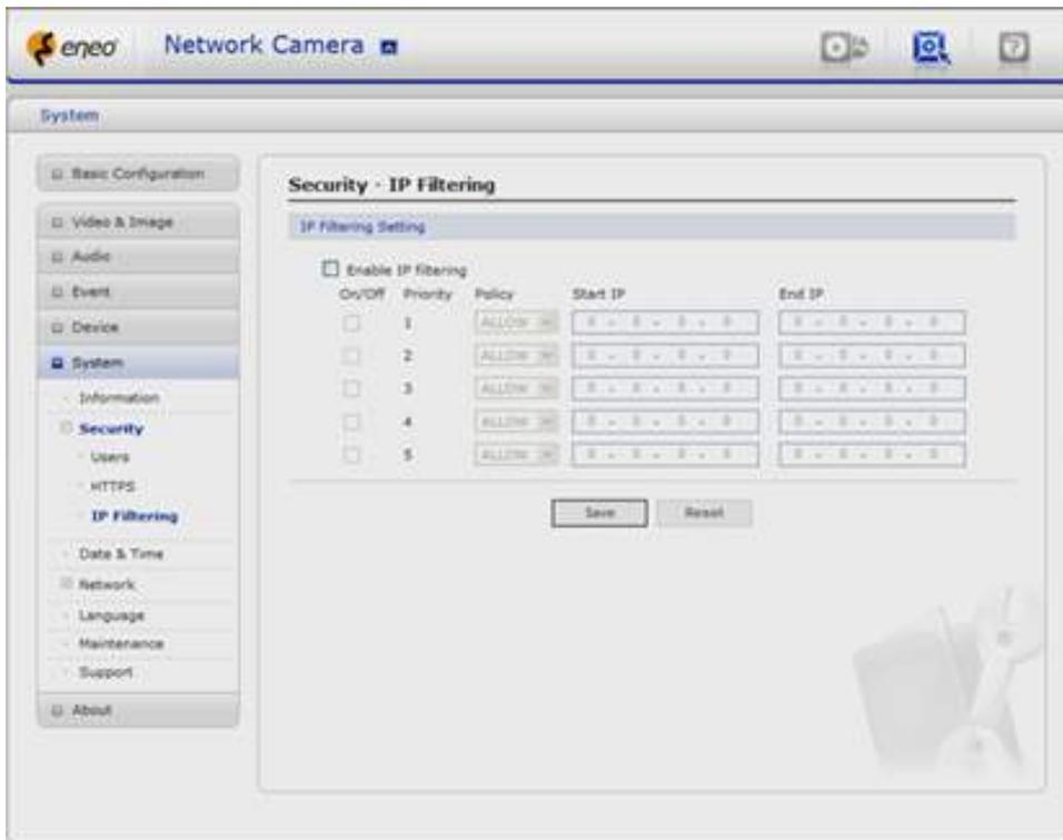
Selezionare la casella **Enable IP address filtering** (Abilita filtro indirizzi IP) per attivare la funzione di filtro degli indirizzi IP. È possibile specificare fino a 256 indirizzi IP (un solo inserimento può contenere più indirizzi IP). Fare clic sul pulsante **Add** (Aggiungi) per aggiungere i nuovi indirizzi filtrati.
