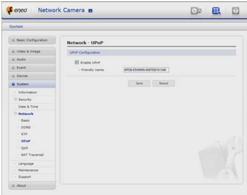
La NLC-1401 include il supporto per UPnP™. UPnP™ è abilitato per default e la NLC-1401 viene quindi rilevata automaticamente dai sistemi operativi e dai client che supportano questo protocollo.
