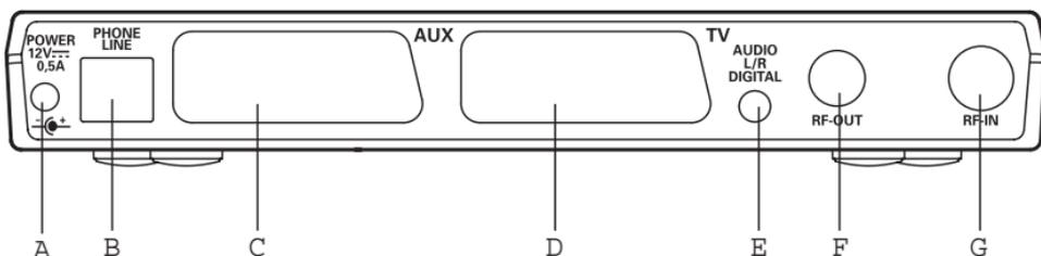
A - Connettore per trasformatore esterno AC/DC
