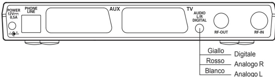
Potete collegare il vostro Set Top Box al vostro amplificatore Hi-Fi (standard, con equalizzatore o per-sino meglio, Prologic) per ottenere un confort di ascolto eccellente paragonabile a quello dei programmi audio. E' possibile regolare il volume direttamente dal Set Top Box solo su uscita analogica.
