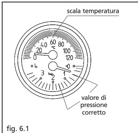
Accertatevi all'inizio della stagione di riscaldamento e di tanto in tanto durante l'utilizzo, che il termoidrometro abbia valori di pressione ad impianto freddo, compresi tra 0,6 e 1,5 bar (scala in colore azzurro), ciò evita rumorosità dell'impianto dovuta a presenza d'aria.
