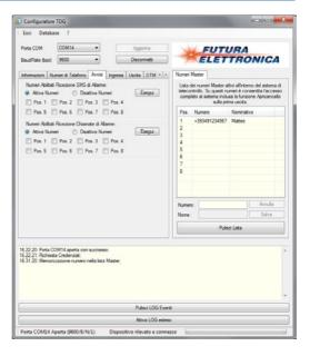
Tramite la scheda "Uscite" è possibile attivare o disattivare la funzione "Ripristino stato Relè su mancanza alimentazione" e di gestire direttamente il relé.
