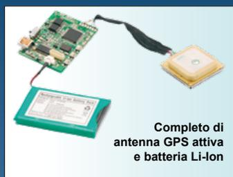
Completo di antenna GPS attiva e batteria Li-Ion
