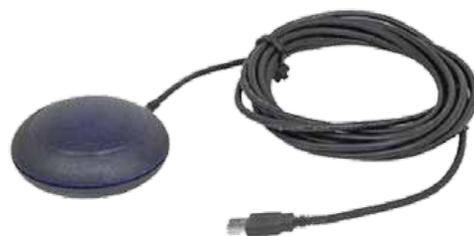
Il NAVISU6USB, dotato del chipset UBX-G6010 della U-blox, è uno tra i più sensibili e precisi ricevitori GPS a 50 canali paralleli presenti sul mercato. Il collegamento USB permette di utilizzarlo con tutti i computer di ultima generazione (viene creata una porta seriale virtuale attraverso la quale invia al PC i dati rilevati). L'apparecchio dispone inoltre di base magnetica che consente un fissaggio rapido su qualsiasi superficie metallica.
