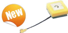
Misura appena 15 x 15 x 6,4mm e dispone di cavo da 90mm intestato con connettore U.FL. Può essere utilizzata con il modulo GPSBEE (non compreso) o con altri ricevitori GPS dotati di tale connettore. Alimentazione 3,3V/5mA; V.S.W.R. (Rapporto Onde Stazionarie) <2.0; guadagno 20dB; peso 15g.
