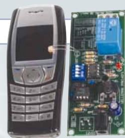
funzionamento: toggle (accesso/spento) oppure acceso con timer per autospegnimento; impostazione del timer 0,5 s, 2 s, 30 s, 1 min, 5 min, 15 min, 30 min e 1 ora; uscite NO e NC con relè da 3 A; alimentazione 12V. Telefono non incluso.
