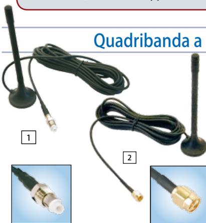
Antenna GSM Quadriband, compatibile con le reti GSM operanti alle frequenze di 850/900/1800/1900 MHz disponibile con attacco FME o SMA. **Caratteristiche:** V.S.W.R. (Rapporto Onde Stazionarie) <1,6; larghezza di banda ± 5 MHz; impedenza 50 ohm; guadagno (senza cavo) 3,5dBi; polarizzazione verticale; lunghezza cavo RG174, 3 m; dimensioni 28,2 x 120 mm; montaggio magnetico/adesivo.
