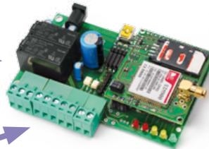
Il dispositivo permette, da remoto, di gestire due utilizzatori o verificare lo stato di vari apparati, sia mediante SMS, sia usando il DTMF da tastiera.
