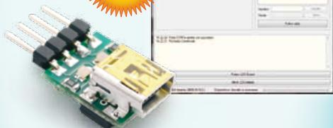
Estremamente compatto, si installa direttamente sulla scheda dei telecontrolli serie TDG1xx per consentire il collegamento con qualsiasi PC dotato di porta USB. Dimensioni 16,5 x 12,2 x 8mm.
