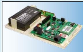
Dedicato al settore della sicurezza e dell'automazione a distanza, dispone di quattro ingressi (NA o NC), e di quattro uscite Open Collector programmabili mediante toni DTMF, chiamata telefonica (menu vocale guidato) e comandi SMS. Sono inoltre disponibili un ingresso reset/blocco e un'uscita guasto. Le 4 uscite del dispositivo possono essere associate, a scelta, ad eventi di allarme oppure essere gestite da remoto per controllare dispositivi di vario
