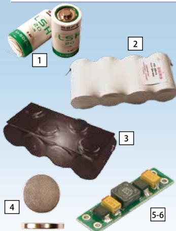
Spesso i dispositivi di localizzazione remota debbono essere installati velocemente e occultati con cura. Per evitare il collegamento all'impianto elettrico della vettura vengono utilizzate batterie usa e getta di elevata capacità e l'insieme batterie-localizzatore viene fissato sotto la vettura con piccoli ma potentissimi magneti.
