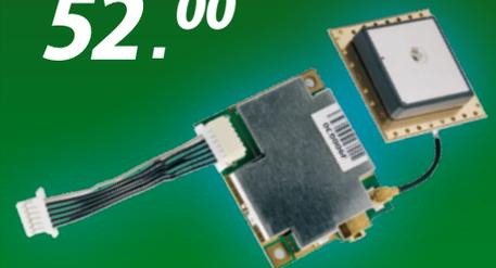
Modulo compatto (30 x 28 x 4,6mm) con Chipset SiRF Star III (20 canali) e sensibilità di -159 dBm, estremamente veloce anche con bassi livelli di segnale. Dispone di antenna patch esterna (18 x 18 x 4mm) con guadagno di 27dB. Supporto NMEA 0183 e protocollo binario SiRF; frequenza L1, 1575,42MHz; cold start 42s; Hot start 1s; riacquisizione 0,1s; alimentazione 3,3V/60mA. **Antenna:** alimentazione 3 ÷ 5Vdc/22mA max.; frequenza 1584MHz; Peak Gain 3,5 dBic min.
