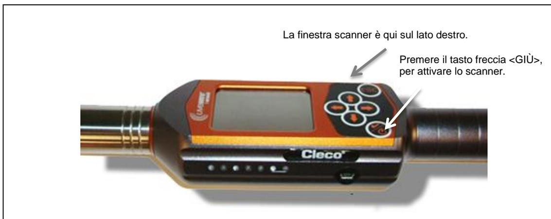
Fig. 27: Azionamento scanner per codici a barre
