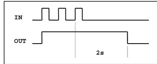
La negazione dell'ingresso di un monostabile, sia esso retriggerabile o meno, dà luogo ad un impulso positivo sull'uscita ma "triggerato" sulla variazione ON→OFF come indicato dalla figura a lato. L'equazione è:
