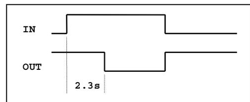
$O1.1 = \text{TIMER}( TI1.1, 0, 20)$  Impulso di due secondi quando  $I1.1$  si chiude (**monostabile**); all'apertura dell'ingresso non succede nulla. Notare che l'impulso sull'uscita viene generato anche se l'ingresso rimane attivo per un tempo inferiore alla durata dell'impulso stesso.
