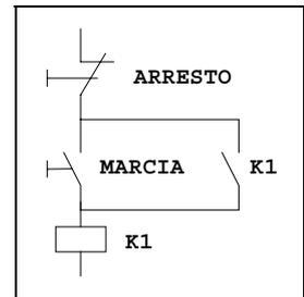
L'equazione equivalente di una cella MARCIA-ARRESTO con MCP diventa:
