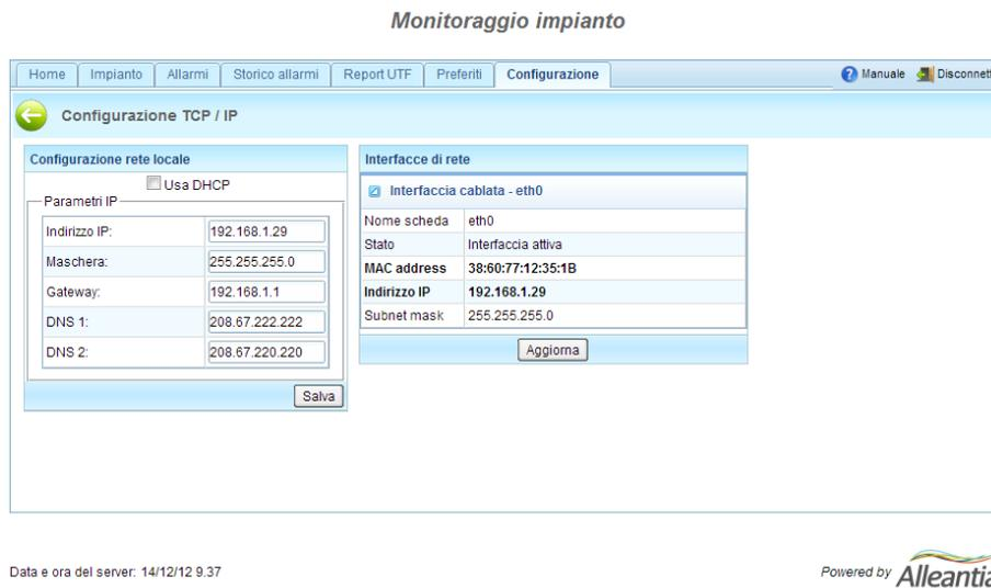
Figura 6 - Configurazione rete
