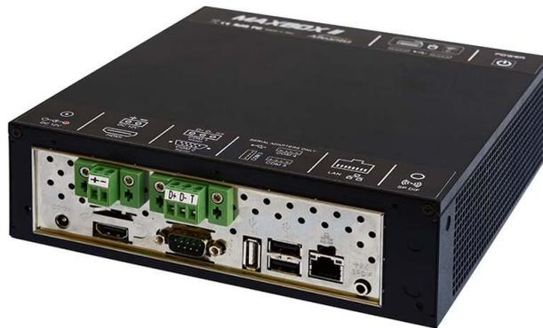
**Figura 1 - Vista posteriore del MaxBox**
