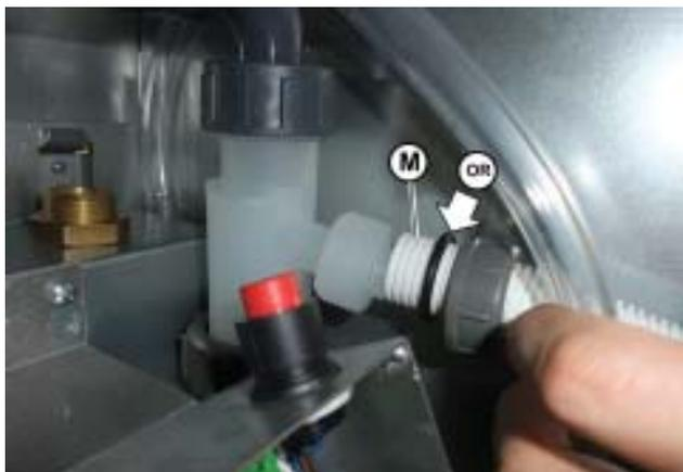
Raccordare il tubo corrugato "M" interponendo l' OR di tenuta, al sifone.
