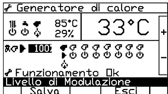
Il sistema si avvierà alla POTENZA MASSIMA = 100% procedere con l'analisi di combustione
