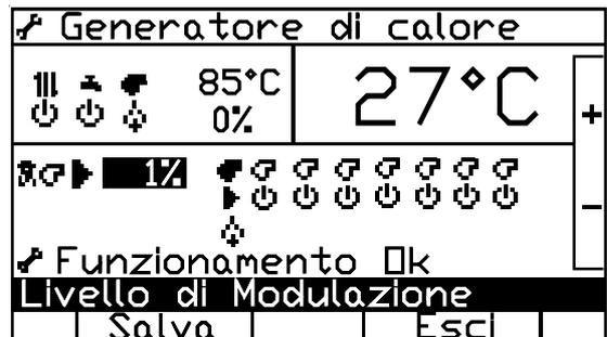
Il sistema si avvierà alla potenza minima: procedere con l'analisi di combustione
