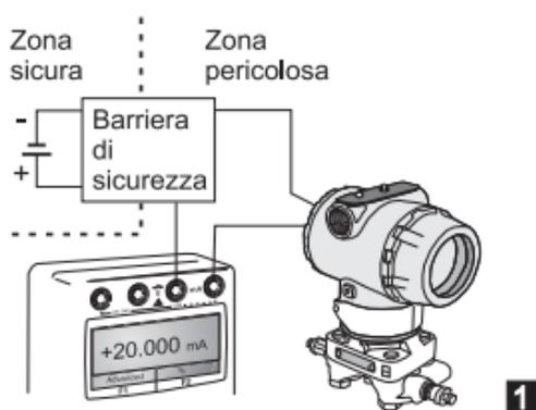
Misurazione della corrente del loop chiuso dal morsetto di prova del trasmettitore
