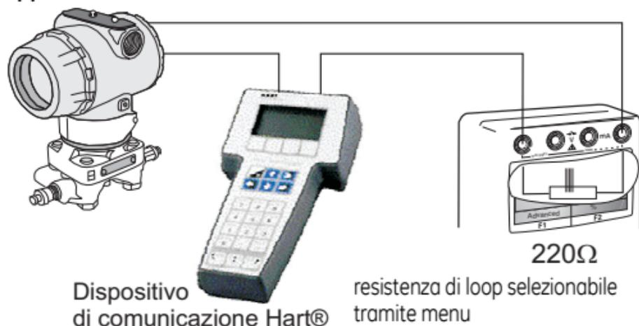
Questa applicazione consente di utilizzare le modalità sorgente e misurazione mA tramite il dispositivo di comunicazione Hart®.
