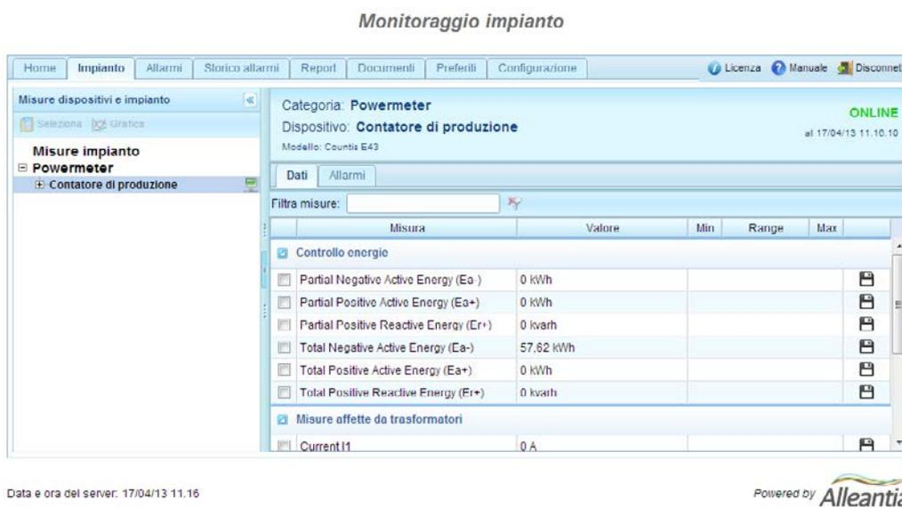
Figura 82 - Misure analizzatore di rete
