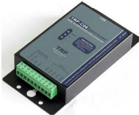
Tali convertitori sono optoisolati fino a 3 kV e forniscono una maggiore protezione contro sovraccarichi e disturbi EMC rispetto alla RS485 integrata. Sono assolutamente necessari quando il cavo seriale della RS485 deve essere posato all'esterno ed è quindi esposto alle scariche atmosferiche.
