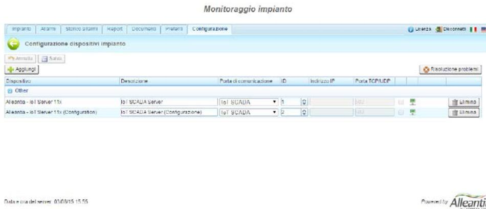
Figura 6 – Dispositivi IOT SCADA SERVER preconfigurati
