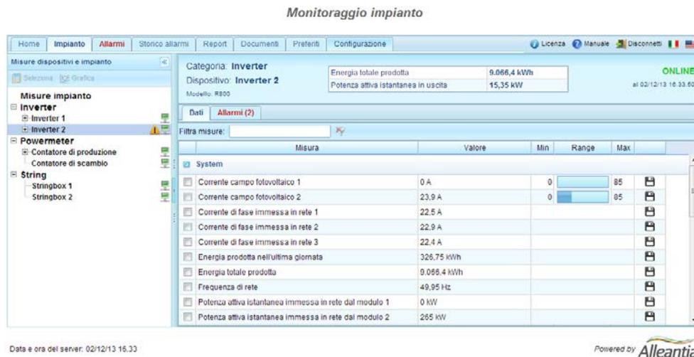
Figura 52 - Visualizzazione misure impianto
