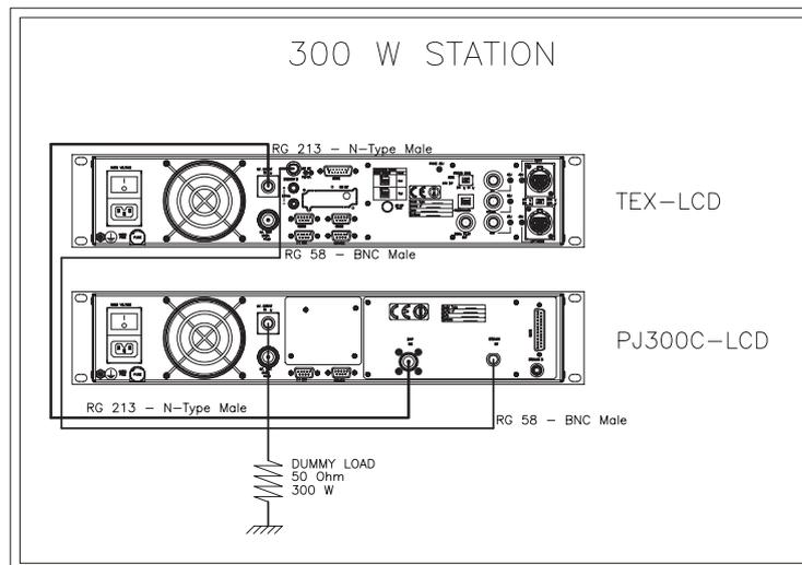
Figura 5.2: collegamenti con l'amplificatore
