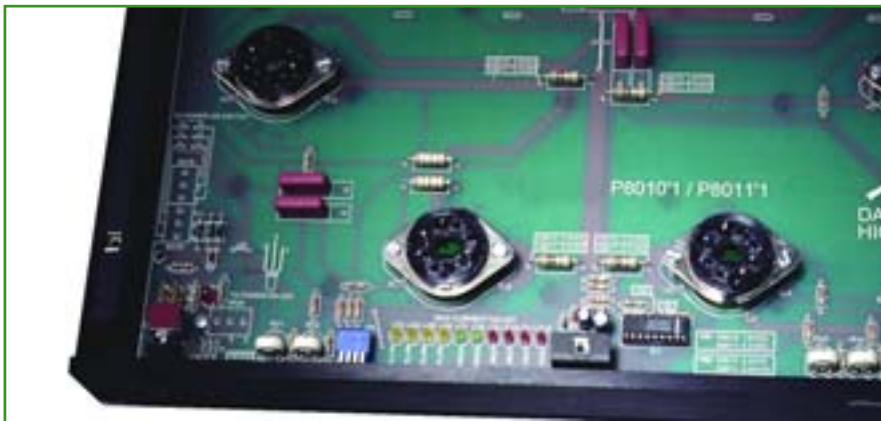
Il vu-meter a led risulta indispensabile per le operazioni di taratura che consentono di compensare lievi differenze costruttive tra le valvole finali.
