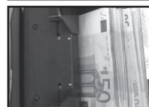
**Nota bene:** Per un conteggio ottimale, mantenere leggermente le banconote con una mano al fine di assicurare una corretta alimentazione delle stesse. Per mantenere le banconote in posizione centrale, utilizzare le guide del caricatore.
