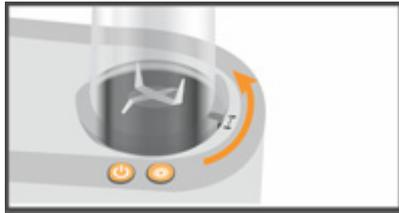
3. Rimuovere le lame ruotando in senso antiorario.
