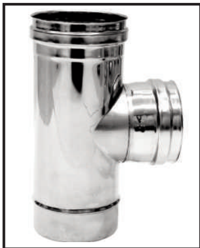
Particolare del raccordo a 90° per ispezione fumi da installare ad ogni cambio di direzione
