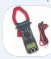
Dispositivo digitale con pinza amperometrica. Display digitale a 3200 conteggi con scala analogica a 33 segmenti. Altezza digit 15 mm, funzione di memoria. È in grado di misurare correnti fino a 1.000 A. Massimo diametro cavo misurazione: Ø 50 mm. Misura anche tensione, resistenza e frequenza. Funzione continuità e tester per diodi. Dotato di retroilluminazione. Alimentazione con batteria a 9V.
