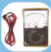
Multimetro analogico per misure di tensioni DC e AC fino a 1000V, correnti in continua da 50 $\mu$ A a 10A, portate resistenza (x1-x10K), diodi e transistor (Ico, I<sub>fe</sub>); scala in dB; selezione manuale delle portate; dimensioni: 148 x 100 x 35mm; alimentazione: 9V (batteria inclusa).
