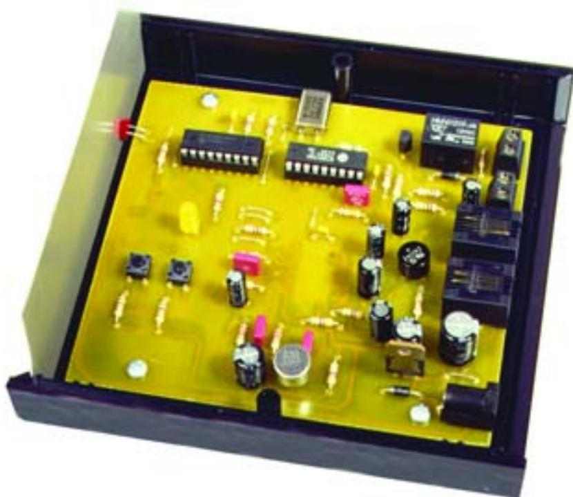
**Progettato esplicitamente per chi raccoglie ordini telefonici, permette di registrare le telefonate componendo dalla tastiera del telefono una sequenza DTMF; nel rispetto della Legge, l'inizio e la fine della registrazione sono preceduti da un avviso vocale ricavato da un lettore digitale basato su chip ISD.**
