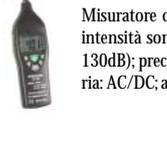
Misuratore con risoluzione di 0,1 dB ed indicazione digitale della misura. È in grado di rilevare intensità sonore comprese tra 30 e 130 dB. Scale di misura: low (da 30 a 100dB) / high (da 60 a 130dB); precisione: +/- 1,5dB 94dB @ 1kHz; gamma di frequenza: da 31,5Hz a 8kHz; uscita ausiliaria: AC/DC; alimentazione: 1 x 9V (batteria inclusa); dimensioni: 210 x 55 x 32 mm.
