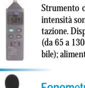
Strumento con risoluzione di 0,1 dB ed indicazione digitale della misura. È in grado di rilevare intensità sonore comprese tra 35 e 130 dB in due scale. Completo di custodia e batteria di alimentazione. Display: 3 1/2 cifre con indicatore di funzione; scale di misura: low (da 35 a 100dB) / high (da 65 a 130dB); precisione: 2,5 dB / 3,5 dB; definizione: 0,1 dB; curve di pesatura: A e C (selezionabile); alimentazione: 9V (batteria inclusa).
