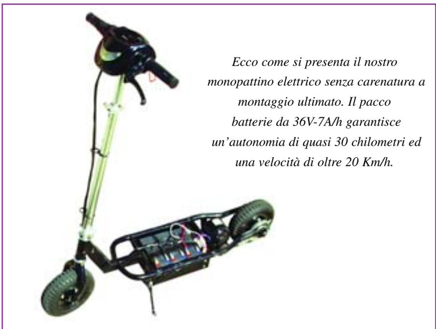
*Ecco come si presenta il nostro monopattino elettrico senza carenatura a montaggio ultimato. Il pacco batterie da 36V-7A/h garantisce un'autonomia di quasi 30 chilometri ed una velocità di oltre 20 Km/h.*
