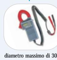
Pinza amperometrica adatta a qualsiasi multimetro digitale. In grado di convertire la corrente da 0,1 a 300 A in una tensione di 1 mV ogni 0,1A misurati. Adatto per conduttori di diametro massimo di 30 millimetri. Dimensioni: 80 x 156 x 35mm; peso con batteria:  $\pm 220$ g.
