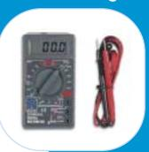
Multimetro digitale in grado di misurare correnti fino a 10A DC, tensioni continue e alternate fino a 750V, resistenze fino a 2 Mohm, diodi, transistor. Alimentazione con batteria a 9V (inclusa). Dimensioni: 70 x 126 x 26 mm.
