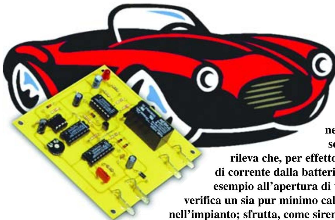
**Sensibile allarme per auto, semplice nella forma ma concreto nella sostanza: scatta quando rileva che, per effetto del prelievo di corrente dalla batteria (dovuto ad esempio all'apertura di una porta) si verifica un sia pur minimo calo di tensione nell'impianto; sfrutta, come sirena, il clacson.**
