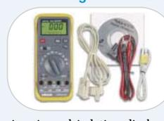
Multimetro digitale dalle caratteristiche professionali a 3 1/2 cifre con uscita RS232, memorizzazione dei dati e display retroilluminato. Misura tensioni in AC e DC, correnti in AC e DC, resistenze, capacità e temperature. Alimentazione con batteria a 9V. Completo di guscio di protezione.
