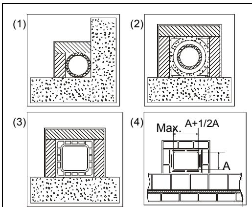
(1) Canna fumaria in acciaio AISI 316 con doppia camera isolata con materiale resistente a 400°C. **Efficienza 100% ottima.**
