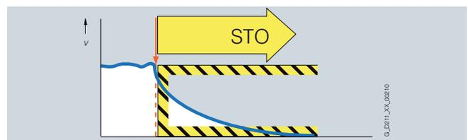
STO è la funzione di sicurezza che garantisce che sul motore non sia più presente energia per la formazione della coppia ed impedisce un avvio indesiderato.
