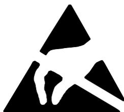
Gli **EGB** possono essere danneggiati da tensione e livelli di energia sensibilmente inferiori a quelli percepibili dagli essere umani. Queste tensioni si verificano quando un componente o un'unità viene toccato/a da una persona che non sia scaricata elettrostaticamente. I componenti che hanno subito tali scariche possono, in molti casi, non essere individuati subito come difettosi; il difetto può verificarsi anche dopo un lungo periodo di funzionamento.
