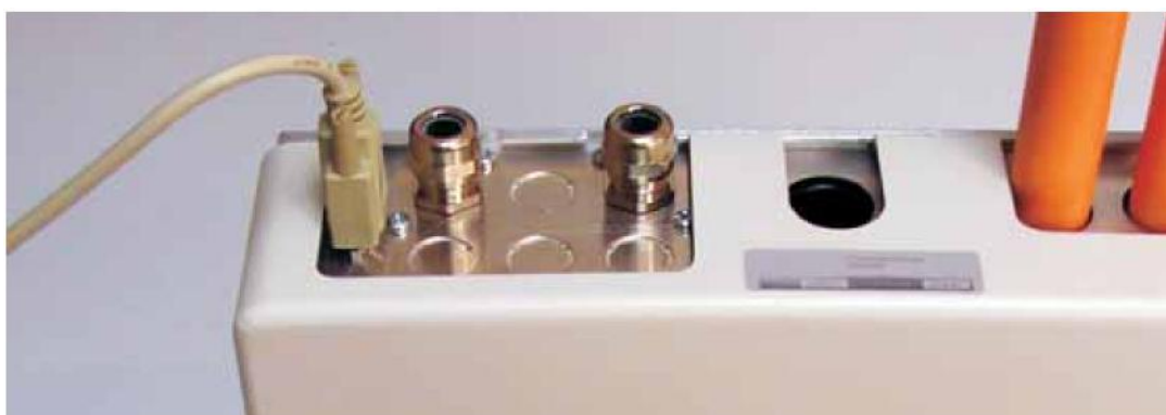
Figura 26: Collegamento di un PC alla porta RS-232 del modulo di comando
