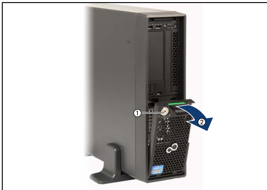
Immagine 12: Rimozione del coperchio del disco rigido
