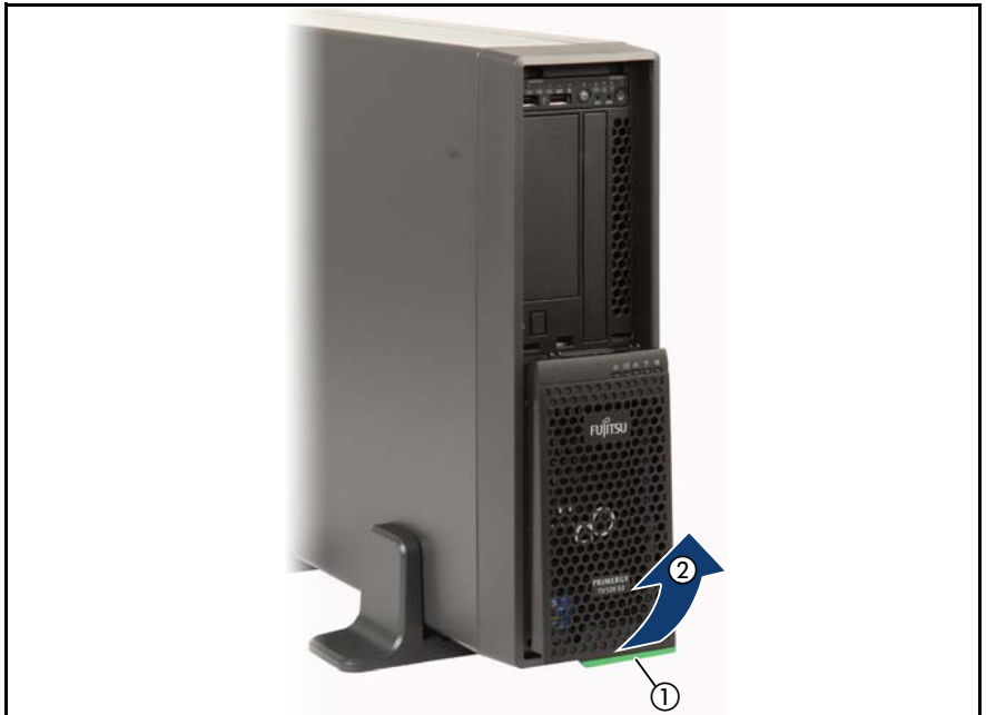
Immagine 11: Rimozione del coperchio dell'unità dal coperchio del disco rigido
