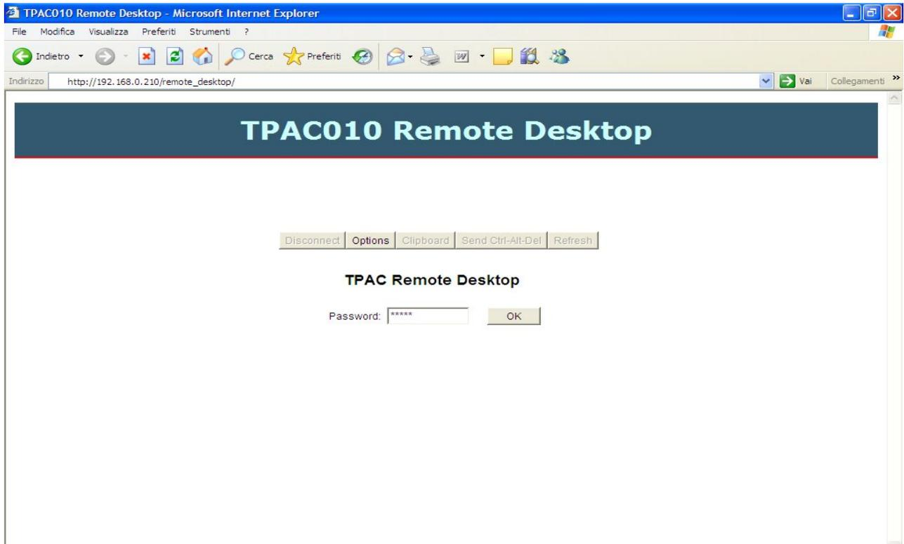
Nella pagina che appare nel browser inserire la password di accesso al pannello e premere OK. La pagina HMI visualizzata sul pannello sarà visibile anche nel browser . Utilizzando il mouse si potrà interagire sulla interfaccia HMI visualizzata nel browser come se si stesse operando direttamente sul pannello. Per interrompere la connessione con il pannello premere “Disconnect”.
