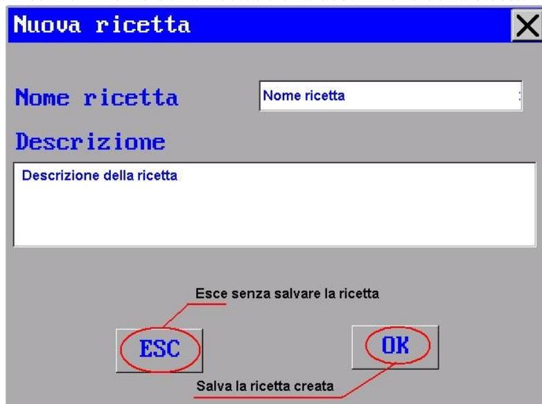
Per inserire il nome della ricetta bisogna toccare il campo **Nome ricetta**, apparirà a video una tastiera virtuale per l'inserimento del nome della ricetta che potrà avere un massimo di 18 caratteri. Terminato l'inserimento premere ↵ sulla tastiera virtuale o **enter** su quella hardware.
