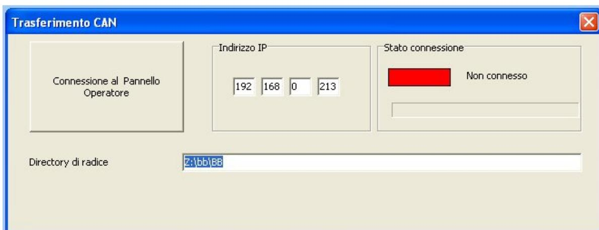
Nella sezione Indirizzo IP è possibile impostare l'indirizzo che il master ha nella rete LAN, quindi premendo il pulsante **Connessione al Pannello Operatore**, si trasferiscono i file di configurazione.
