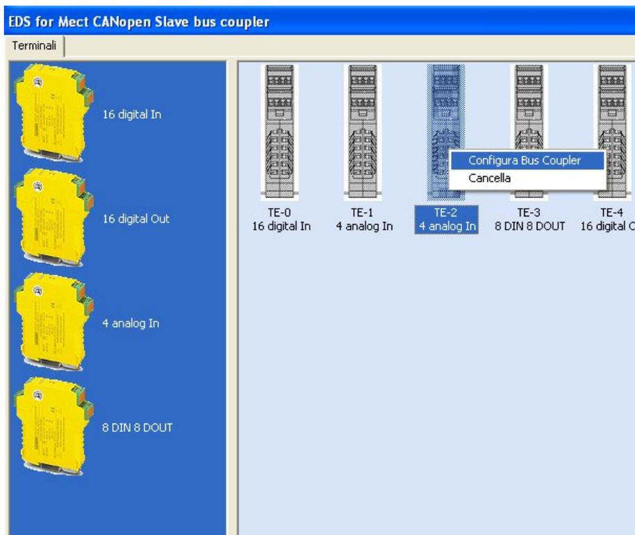
I canali dei terminali analogici hanno la possibilità di essere configurati individualmente. Selezionando un terminale analogico e premendo con il tasto destro del mouse appare il menu di popup. Selezionando configura bus coupler appare la seguente finestra nella quale sono elencati i canali componenti il terminale.
