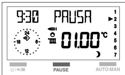
Premendo una seconda volta il tasto PAUSE è possibile iniziare ad impostare le ore di interruzione, fino ad un massimo di 24 ore. Il display si presenta come in figura.
