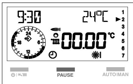
Premendo una volta il tasto PAUSE, il display visualizza al posto della temperatura ambiente quattro zeri.
