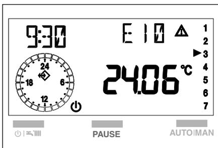
⚠ Quando, durante la funzione di sblocco, i tasti PAUSE e AUTO MAN **non vengono premuti contemporaneamente** si verifica un cambiamento dello stato di funzionamento.
