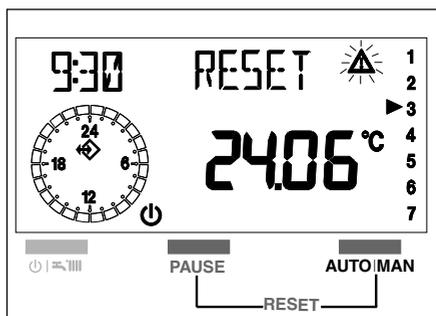
⚠ Quando, durante la funzione di sblocco, i tasti PAUSE e AUTO MAN **non vengono premuti contemporaneamente** si verifica un cambiamento dello stato di funzionamento. In questo caso riposizionarsi sulla funzione desiderata come indicato nel paragrafo "5.1.1 Scelta del modo di funzionamento".
