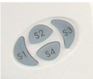
I tasti **S1, S2, S3, S4** svolgono diverse funzioni di inserimento/disinserimento parziale dei settori specifici globali o di area, durante la fase di programmazione, sono retroilluminati e al centro è posizionato il lettore per la chiave di prossimità.
