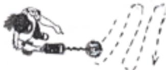
Se si sente un suono "di-di" durante il movimento, esso indica che c'è un target di metallo nell'area sondata. In questo caso, è possibile utilizzare "LOCALIZZAZIONE TARGET" per localizzare il target. Poi utilizzare "DISC" o "DISC/TONE" per determinare se vale la pena estrarre il target.
