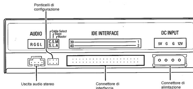
Figura 17. Connettori posti sul lato posteriore del CD-ROM.
