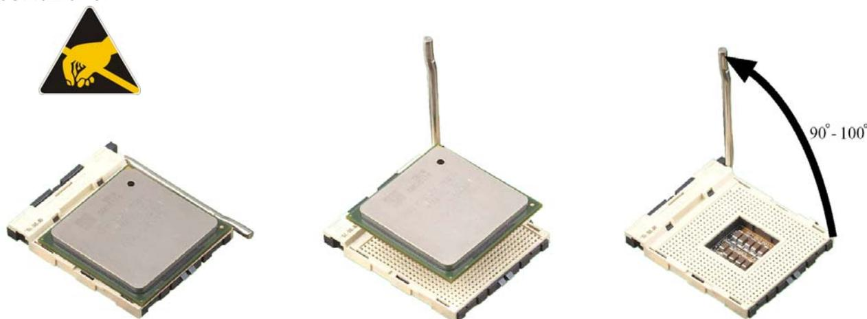
Figura 7 Inserimento/disinserimento della CPU
