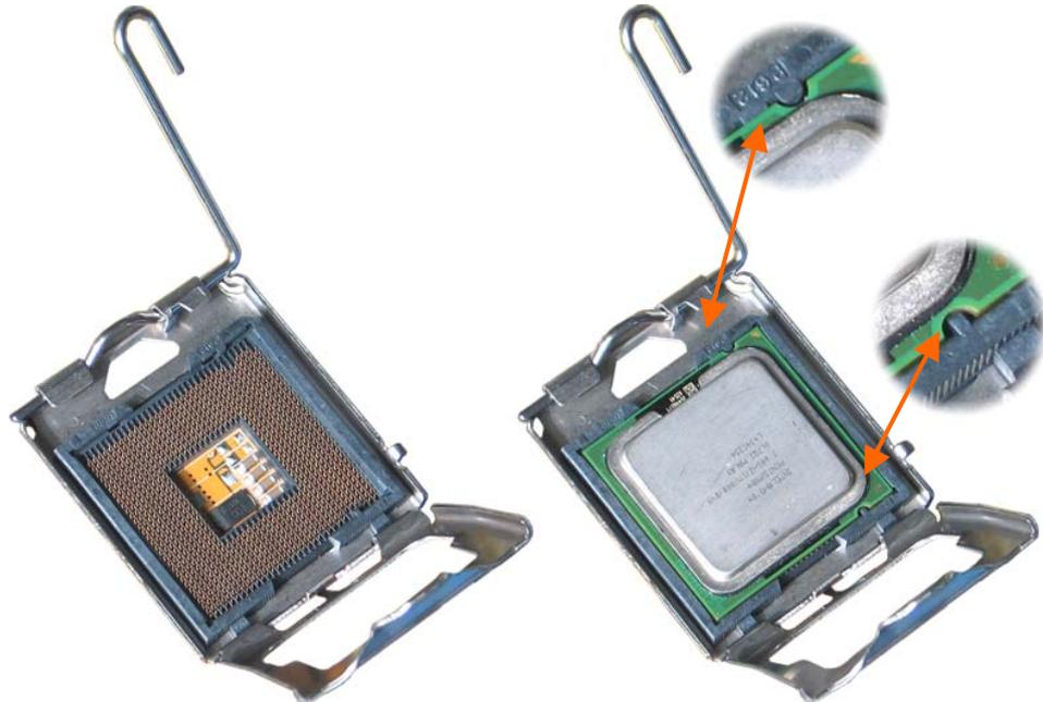
Figura 10. Posizionamento CPU
