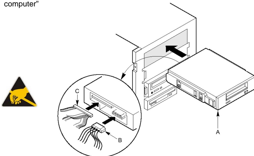
Figura 14. Connessioni al dispositivo da 5.25"
