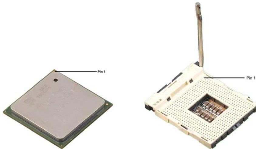
Figura 8. Posizionamento CPU
