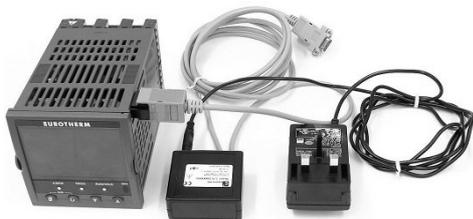
2. Utilizzando una clip di configurazione che si inserisca a lato del regolatore.
