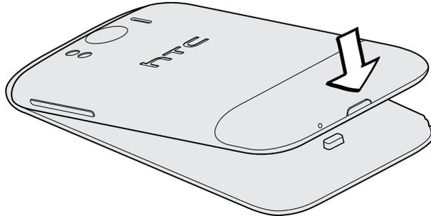
3. Premere il coperchio posteriore per bloccarlo in posizione. Viene emesso un clic quando il coperchio posteriore è bloccato in posizione.
