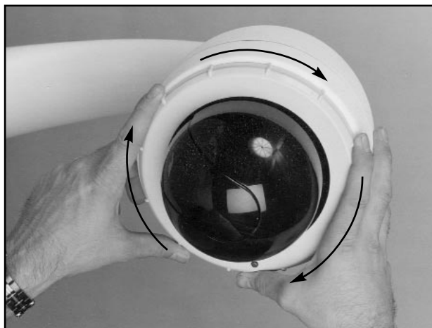
Foto 8: Come avvitare il Corpo Camera
