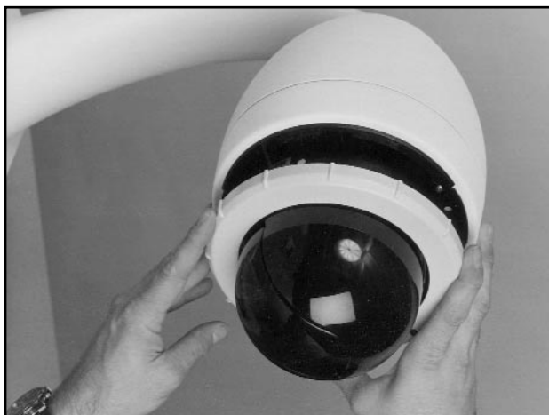
Foto 7: Come inserire il Corpo Camera
