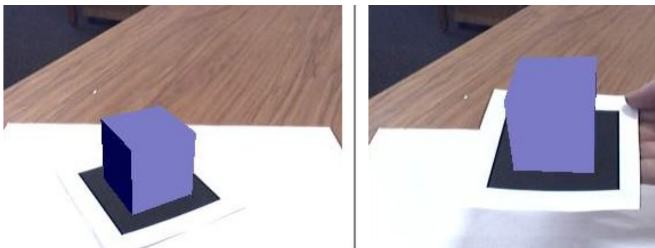
Figura 2.12: Nell'esempio ArToolKit disegna l'oggetto tridimensionale (un cubo) nella stessa posizione ed orientamento del marker.
