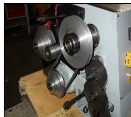
Figura 3– Targa e pulegge della velocità del mandrino.
