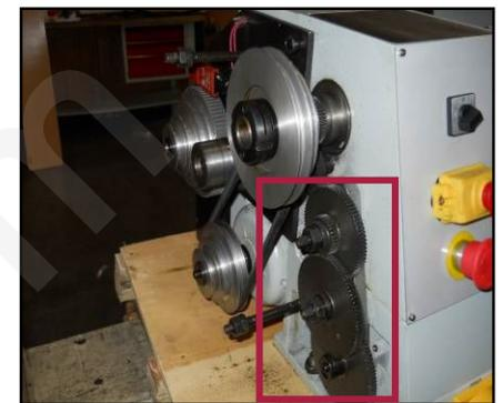
Figura 5 – Ingranaggi avanzamenti.
