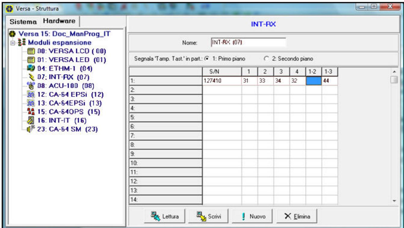
Figura 22. Registrazione di un telecomando P-4/T-4 nel modulo INT-RX ed assegnazione delle funzioni ai pulsanti (esempio di programmazione).
