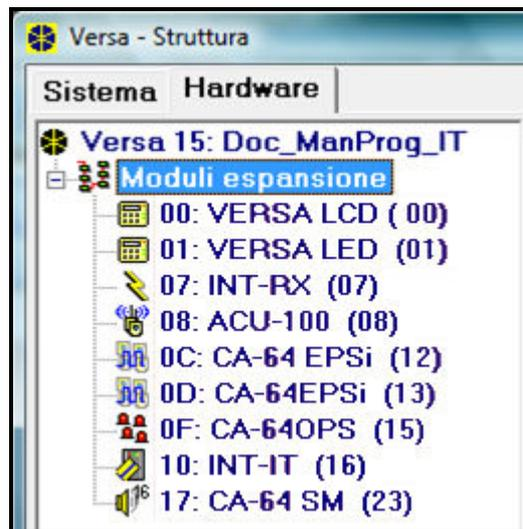
Figura 13. Elenco dei dispositivi identificati dalla centrale mostrato nella scheda "Hardware" nella finestra "Versa – Struttura" (esempio di programmazione).
