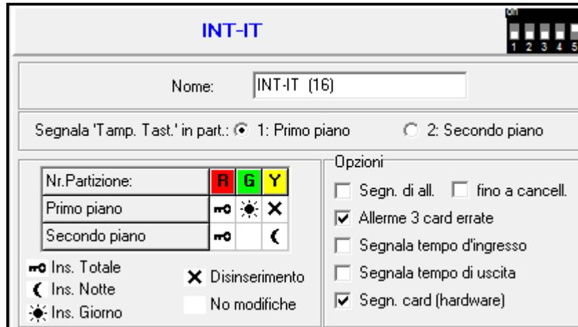
Fig. 17. Impostazioni del lettore di tessere di prossimità INT-IT con il programma DLOADX (esempio di programmazione).
