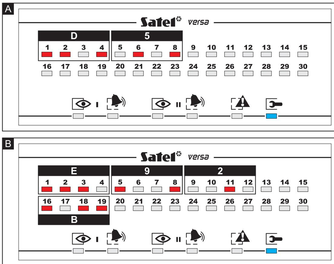
Fig. 2. Esempi di presentazione dei valori decimali attraverso l'ausilio dei LED di zona nella tastiera VERSA-LED-GR. Nell' esempio A è programmato il valore esadecimale a due cifre D5; nell'esempio B il valore esadecimale a quattro caratteri: E92B.
