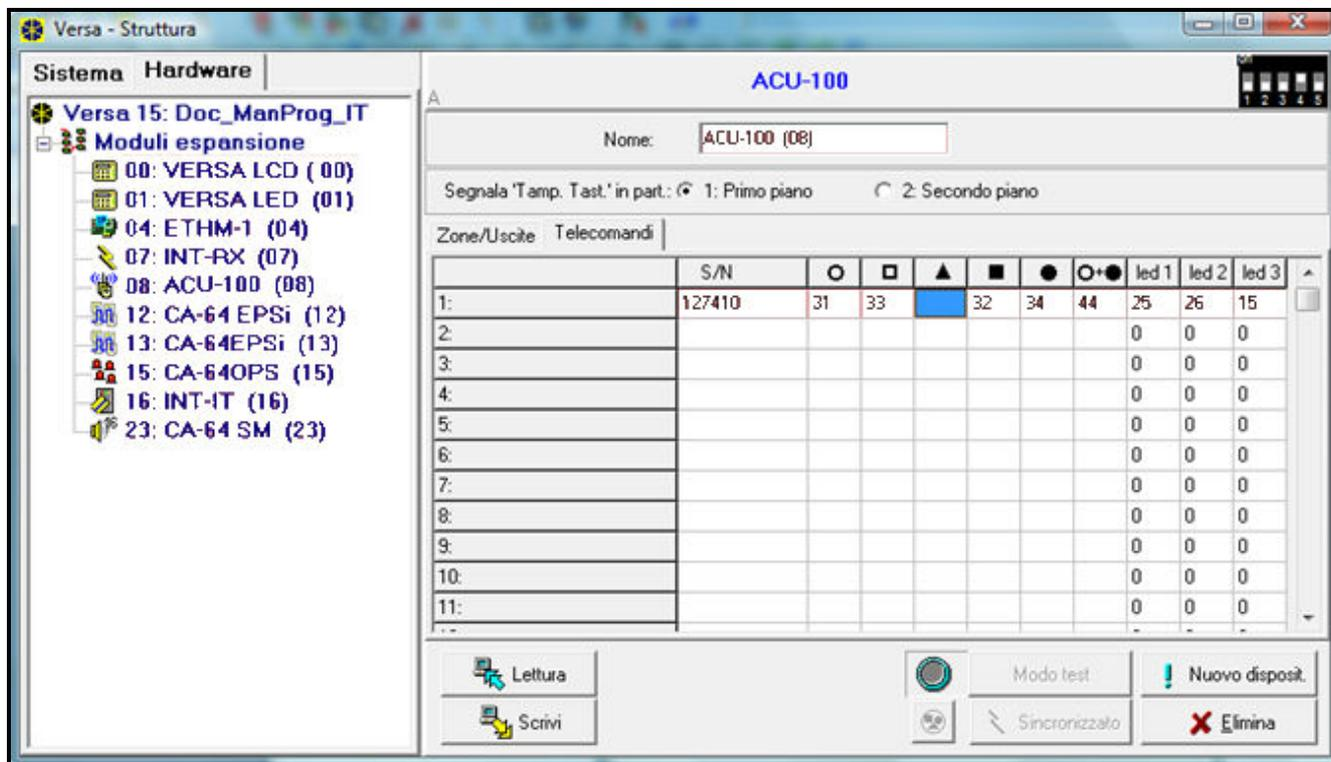
Figura 23. Registrazione di un telecomando APT-100 nel modulo ACU-100, assegnazione delle funzioni ai pulsanti e delle conferme ai LED (esempio di programmazione).
