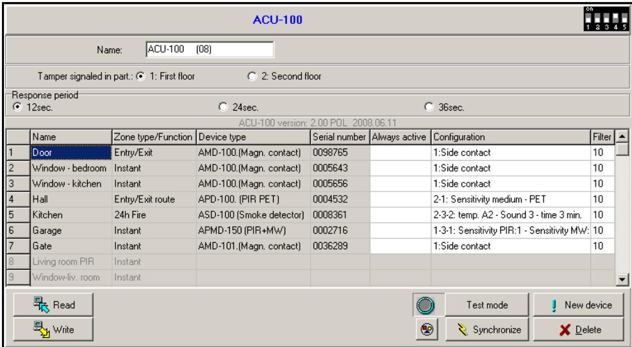
Figura 16. Impostazioni del controller ACU-100 e dei dispositivi del sistema senza fili ABAX con il programma DLOADX (esempio di programmazione).
