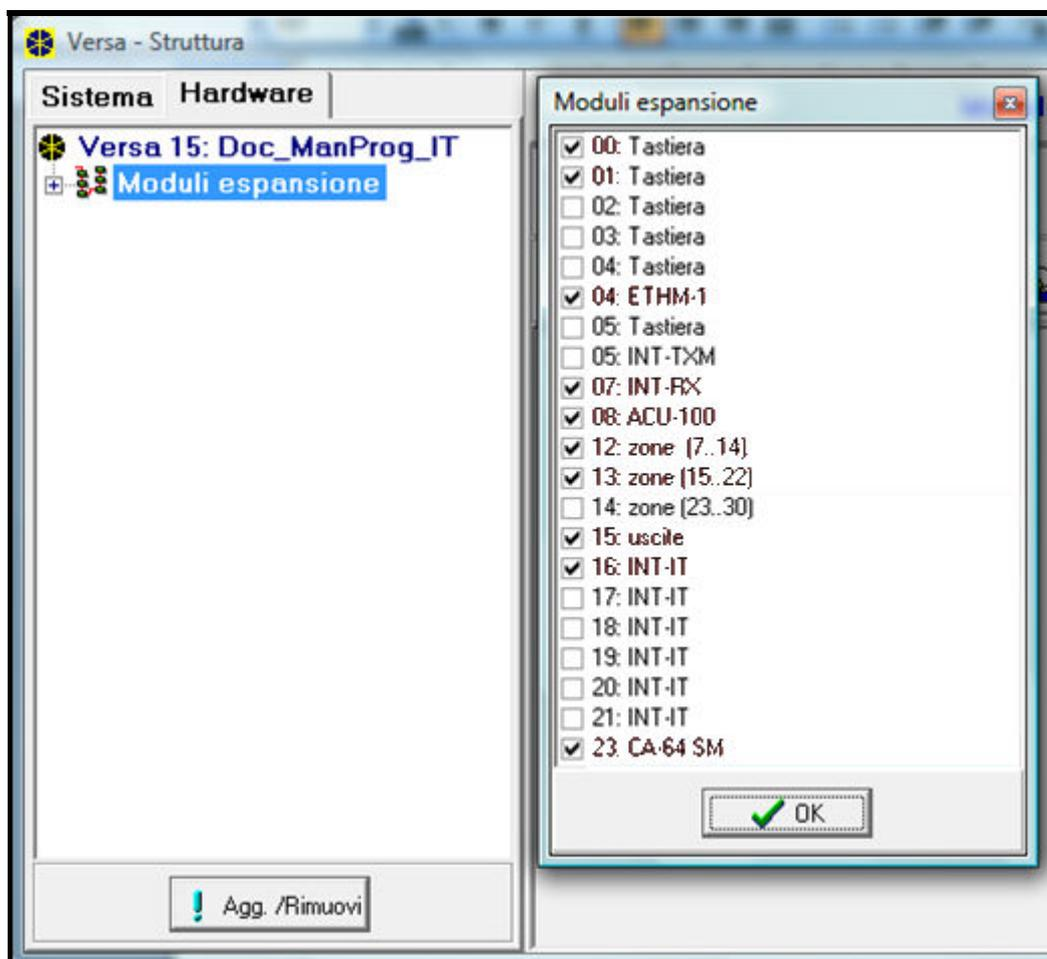
Figura 14. Elenco dei moduli e tastiere integrabili nel sistema.
