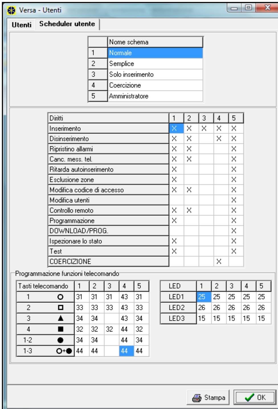
Figura 21. Impostazione dei modelli utente nella finestra "Versa – Utenti" del programma DLOADX (esempio di programmazione).
