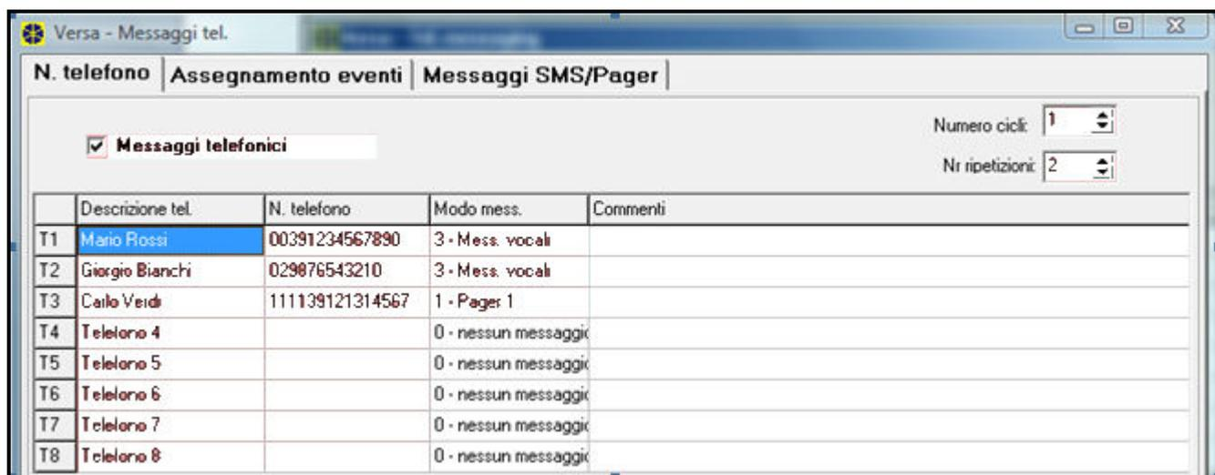
Figura 20. Configurazione dei parametri della finestra "Messaggi" nel programma DLOADX (esempio di programmazione).
